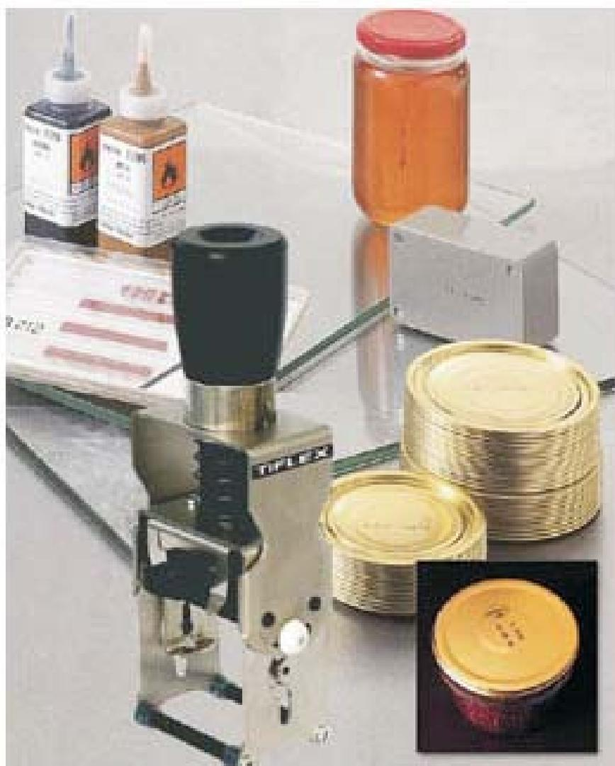
Sobre una base extriada de 60 x 20 mm podemos componer el texto, signos o referencia a marcar. En posición normal, el texto compuesto se apoya sobre la almohadilla entintadora. Cuando presionamos sobre el émbolo, gira 180° el sello y marca sobre la superficie de apoyo. Al dejar de presionar, vuelve a la posición inicial volviéndose a entintar y queda preparada para realizar la siguiente marca.
